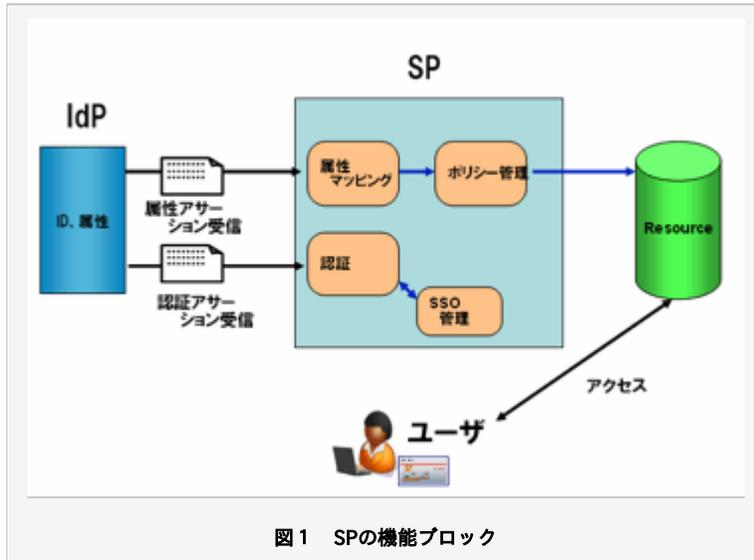
図1 SPの機能ブロックは、SPの機能を単純化したブロックで示しています。SPはIdPと連携して、以下の2つの動作を行います。
